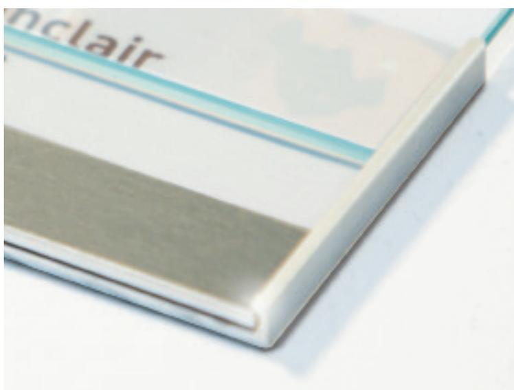
Die sehr flache Bauweise von nur 7 mm ist nur ein Merkmal der SmartFix Schilderserie. Das 3-teilige Schild besteht aus einem Aluminiumprofil Silber eloxiert mit seitlichen Führungsschienen, einer 3mm starken Abdeckung aus thermisch gehärtetem Glas und einer dünnen Einlage aus Aluminium gebürstet mit einer Z-Falz am oberen und unteren Rand. Diese hält die Glasabdeckung und macht den Einlegerwechsel sehr einfach und schnell.
